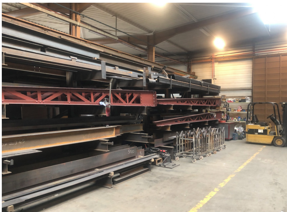
Éléments en acier déconstruits et stockés en vue d'un nouvel usage - © Général Métal Édition
